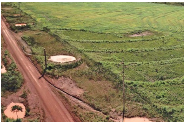
Exemplos de ações implementadas no âmbito do Projeto: à esquerda, terraços e barraginhas (Foto: Emater-DF); e à direita, durante as obras de tubulação do Canal Santos Dumont (Foto: ADASA).
