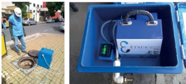
Figura 2: Amostragem sendo realizada em um dos pontos de monitoramento. Detalhe para a parte interna do amostrador automático de líquidos Étsus 1000.
