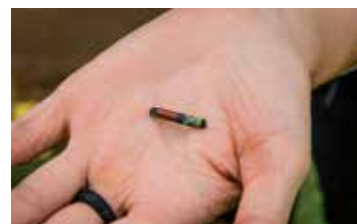
O pit-tag é um receptor eletrônico minúsculos, que não atrapalha o peixe. Fotos: Rubens Fraulini
